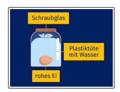
Auf dem Bild siehst du den Aufbau eines Experiments. Du siehst ein Glasgefäß, in dem sich eine Plastiktüte mit Wasser befindet. Darin liegt ein rohes Ei, das normalerweise sehr zerbrechlich ist. Wird nun das Gefäß geschüttelt, passiert dem rohen Ei jedoch nichts, denn es wird von dem Wasser in der Plastiktüte geschützt.
