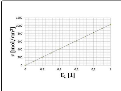
Um im Labor mithilfe des Lambert-Beerschen Gesetzes Konzentrationen genau zu bestimmen, verwendet man die Methode der **Kalibrierfunktion** bzw. Eichkurve. Dabei werden verschiedene Lösungen mit bekannter Konzentration an einer bekannten Substanz hergestellt und dessen Extinktion bei einer festen Wellenlänge vermessen. Die Auftragung der Extinktion über die Konzentration (oder umgekehrt s. *Abb.*) liefert nach dem Lambert-Beerschen Gesetz einen **linearen** Zusammenhang:
