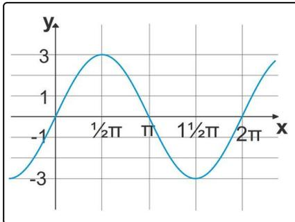
Betrachten wir die modifizierte Sinusfunktion. Diese sieht in etwa so aus wie eine Welle, die sich ausbreitet. Um festzustellen, wie laut eine solche Schallwelle ist, betrachten wir die **maximale Auslenkung** oder **Amplitude** der Welle.
