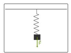
An eine unbelastete Schraubenfeder wird ein Gewicht mit einer Gewichtskraft von **70 Newton** gehangen. Dabei dehnt sich die Feder um **0,85 Meter** aus.
