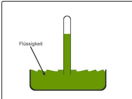
Ein einfaches Manometer besteht aus einer offenen Schale, die mit einer Flüssigkeit gefüllt ist. Daren taucht ein nach oben geschlossenes, evakuiertes Glasrohr. Der Druck der Atmosphäre bewirkt, dass die Flüssigkeit im Glasrohr aufsteigt, da hier der Atmosphärendruck nicht wirkt. An der Höhe der Flüssigkeit im Glasrohr kann der Außendruck abgelesen werden. Nenne Gründe dafür, warum bei Manometern dieser Art Quecksilber eine geeignete Flüssigkeit darstellt.
